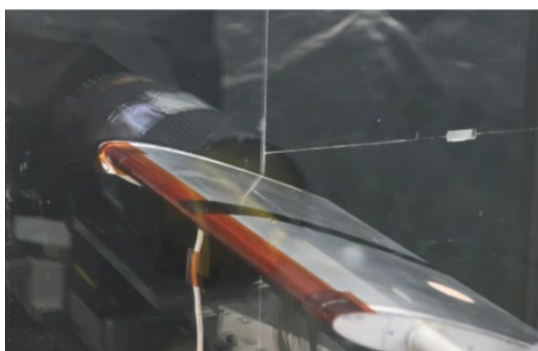
図 3 風洞に設置した 2 次元翼模型
