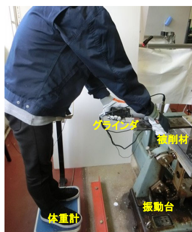
図2 手腕振動測定実験の様子
