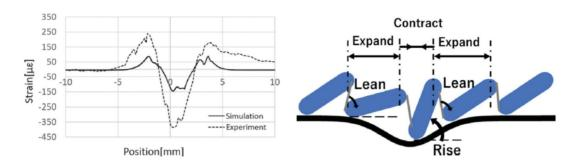
・なぞり触感の増幅を相関が高いと考えるセンサデータから ,触感の増幅を観測することができた . 高さ , および , 深さ 5um の触覚プレートを , 提案する増幅デバイス ( スパイラルコイル ) を使ってなぞった場合と , それを使わないでなぞった場合のセンサデバイスからの出力信号を下の図に示す . 上の段が凸形状を , 下の段が凹み形状をなぞったとき結果である . 実線が増幅デバイスを使ってなぞった時で , 振幅が何もつけないでなぞった時のデータを表す点線に比べて大きいことが確認できる .
