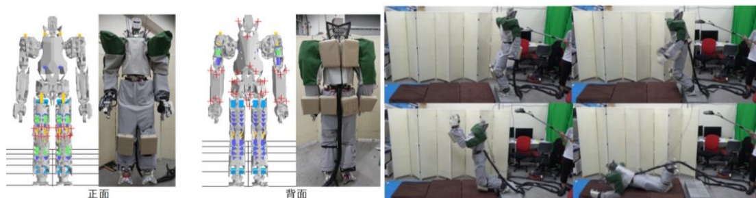
図1：モジュール装着ロボットと転倒実験（文献①）
