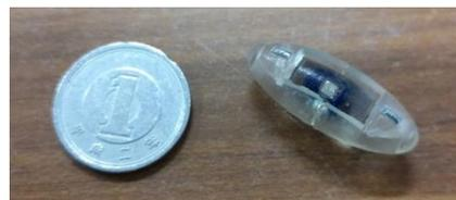
図6 作成した磁気駆動ロボット
