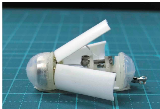
図2 生検機構駆動時の様子
