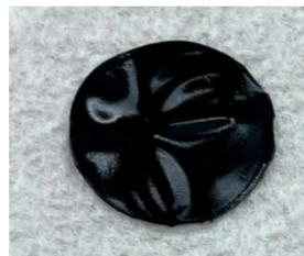
図 2. 液中において作製した PEDOT:PSS 自立膜
