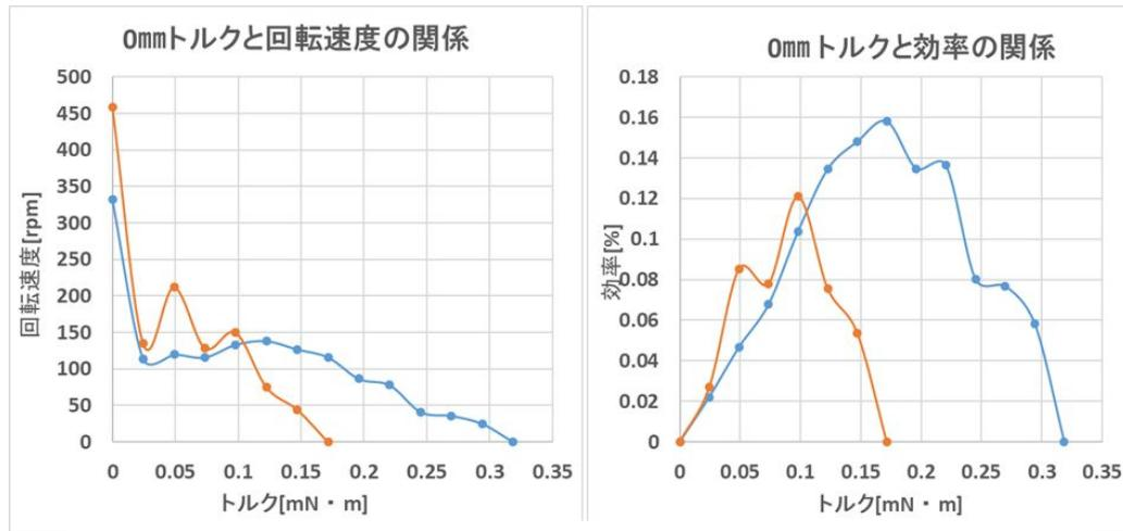
図9 超音波マイクロモータの負荷特性
