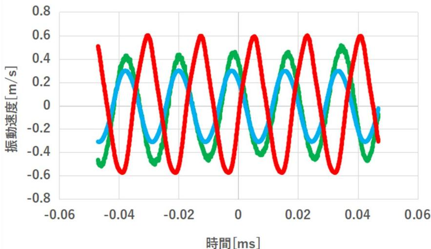
図5 スプリングワッシャを利用した場合の振動速度およびその位相
