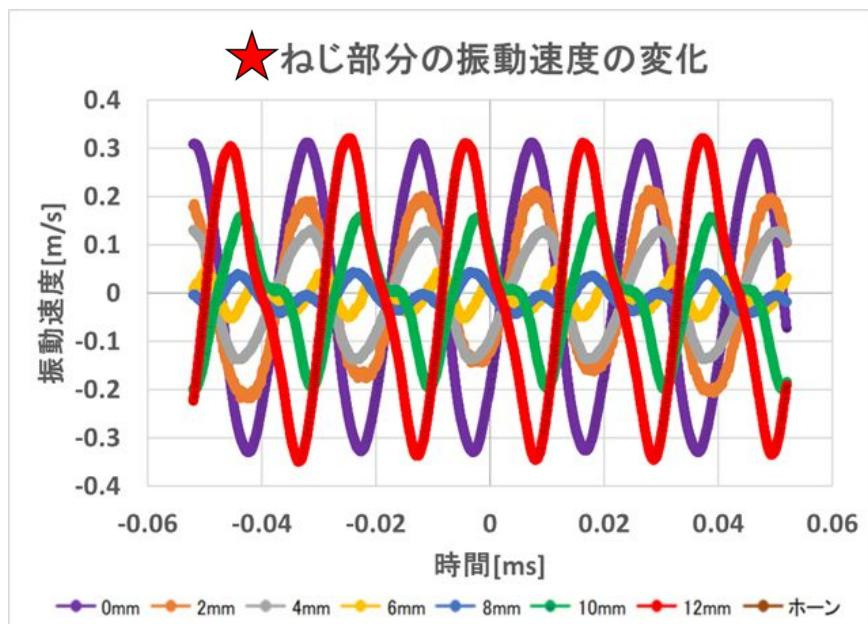
図 8 スプリングワッシャを利用した場合の振動速度およびその位相
