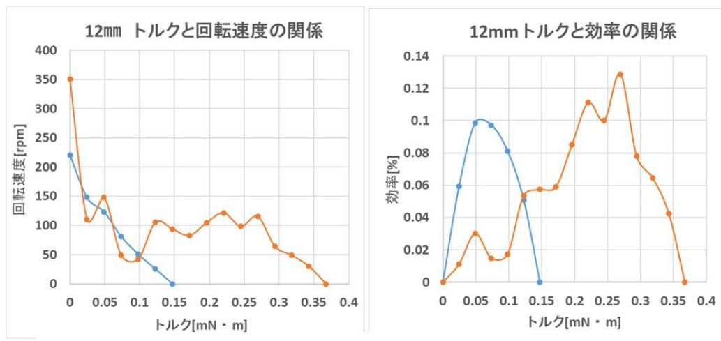
図10 超音波マイクロモータの負荷特性
