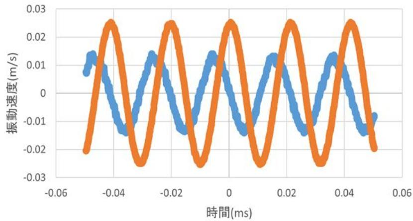
図3 コイルスプリングを利用した場合の振動速度およびその位相
