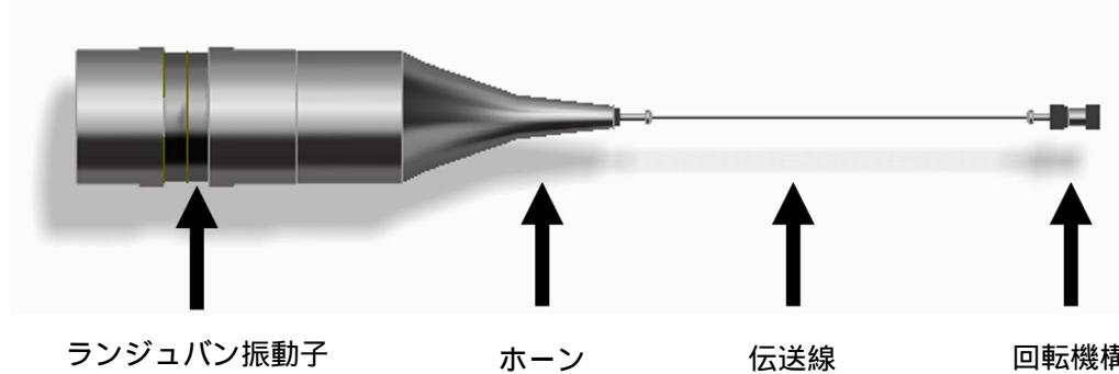
図1 伝送線を利用した超音波マイクロモータの案
