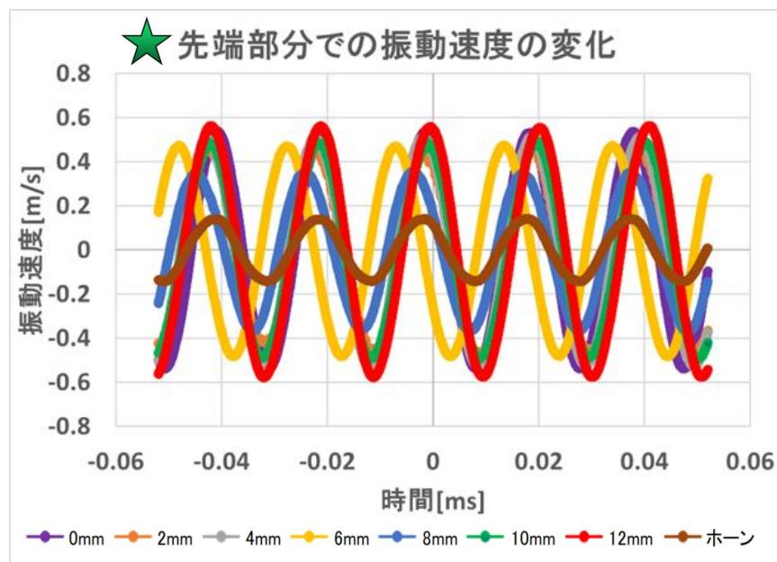
図 7 スプリングワッシャを利用した場合の振動速度およびその位相
