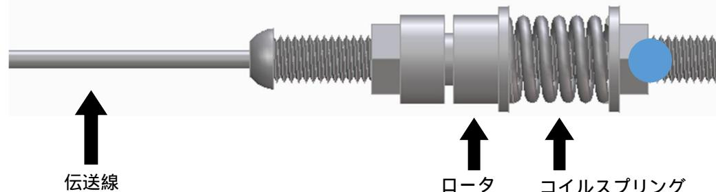
図2 コイルスプリングを利用した回転機構の案
