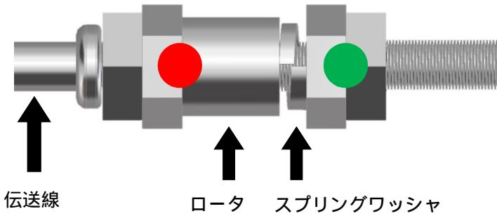
図4 スプリングワッシャを利用した回転機構の案
