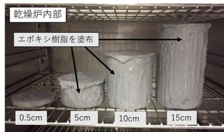
写真 - 1 水分逸散試験
