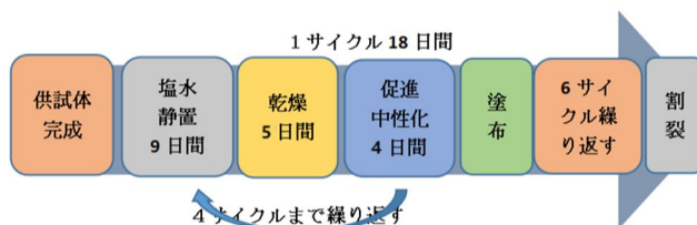
図1 既設構造物を想定した試験の流れ
