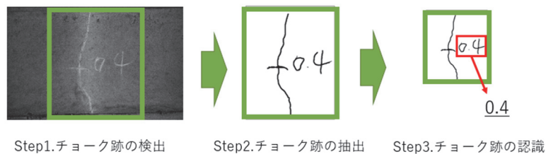
図-2 チョーク跡自動認識の流れ
