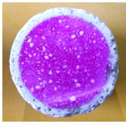
図4 硫酸浸食による中性化
