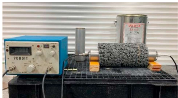
写真-2 超音波試験の測定の様子 (円柱試験体の場合)
