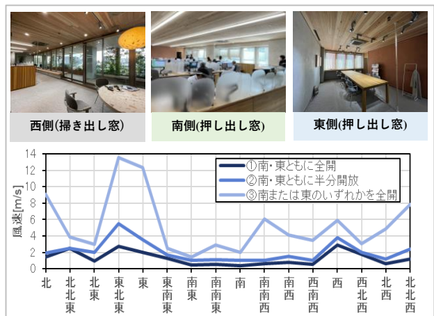
図5 CFDによる16風向別必要外部風速算出結果
