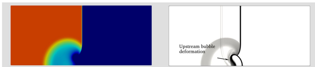
図 8 数値散逸修正版 SLAU2 を用いた混相流計算：水中衝撃波・気泡干渉
