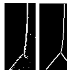
図6 図1の例の衝撃波検知結果(白色部分): (左)従来法, (右)本研究
