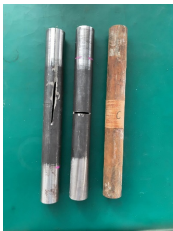
(a) き裂・腐食した金属管
