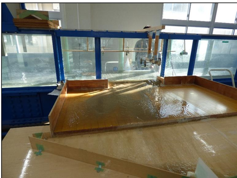
写真 5 : 杭設置による土砂捕捉
