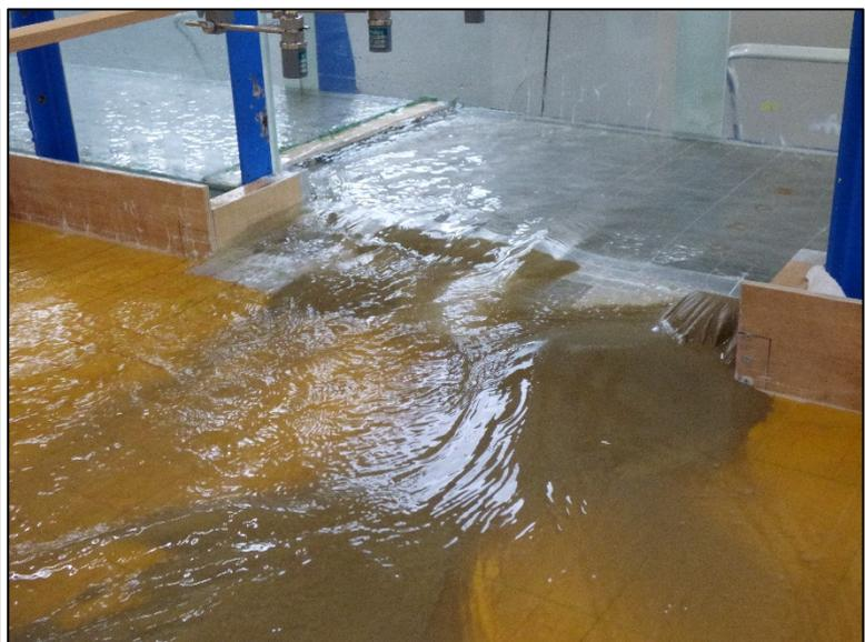
写真 4 : 橋脚による堰上げの影響
