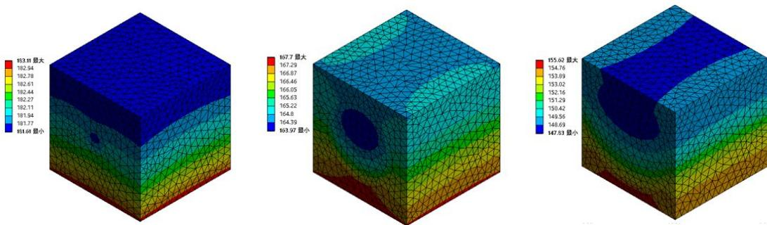
Fig.4 熱遮蔽 : NiTi ワイヤ直径 D=7 mm (上面温度 181 ) , 21 mm (164 ) , 28 mm (147 )
