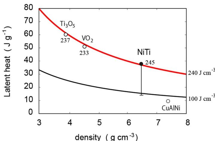
Fig.1 形状記憶合金 NiTi と CuAlNi, 酸化物  $\text{Ti}_3\text{O}_5$ ,  $\text{VO}_2$  における潜熱と密度の関係。等高線は単位体積あたりの潜熱量。NiTi 合金における最大値は本研究で測定した。
