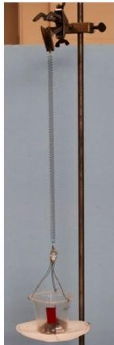
Fig.7 NiTi コイルばねによって 120 g の重りを持ち上げる実験。温度曲線が青線で、変位が赤である。温度曲線に平坦部がある間にマルテンサイト変態が起こっていて、そこで重りを 200 mm 持ち上げている。通電加熱のための電力を求めて、このばねの熱力学的な効率を決めることが出来る
