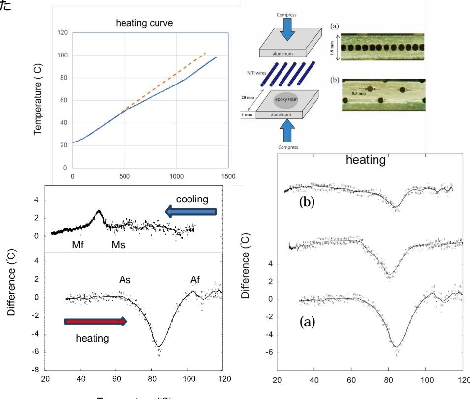
Fig.6 NiTi+AL 複合体の作製 (右上) と試料(a)の加熱曲線 (左上) 試料 (a) の加熱・冷却過程の DTA 曲線 (左下) , 加熱過程における DTA 曲線の比較 (右下) NiTi ワイヤの本数が多いほどピーク面積は大。
