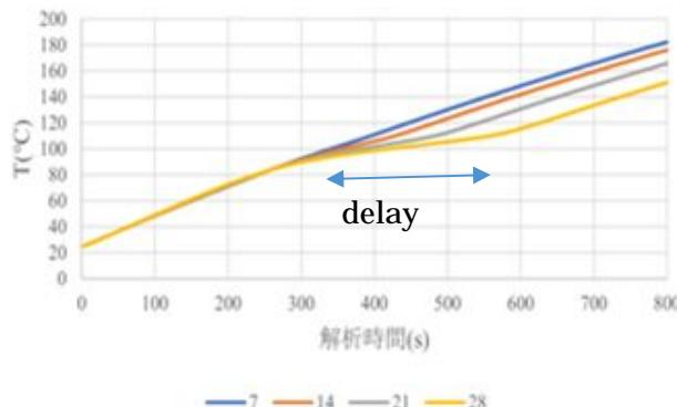
Fig.5 NiTi/Al 複合体の加熱曲線のシミュレーション。NiTi ワイヤの直径が大きくなると遅延時間が長くなる。この遅延時間が蓄熱効果である。
