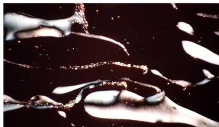
(2) CNT分散能の評価ならびに高濃度分散液の調整と物性評価：新規に合成した4種類の化合物は、いずれもCNTを分散する性質があることがわかりました。しかし、その分散能には差があり、ジメトキシピフェニルを主骨格とする化合物が最も分散性が良いことがわかりました。そこで、ジメトキシピフェニル主骨格分散剤と、以前合成したアゾベンゼン主骨格分散剤を用いて、高濃度分散剤を作製したところ、右のように、偏光顕微鏡観察により、液晶性が発現していることがわかりました。
