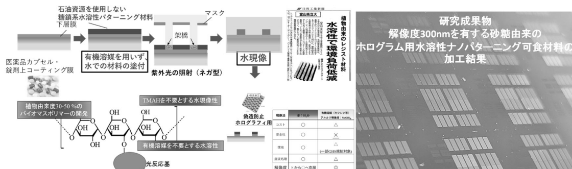
図2 天然資源を活用した砂糖由来の水溶性ナノマイクロパターンニング材料 (レジスト) のフォトリソグラフィプロセスとホログラムパターンのナノ加工結果
