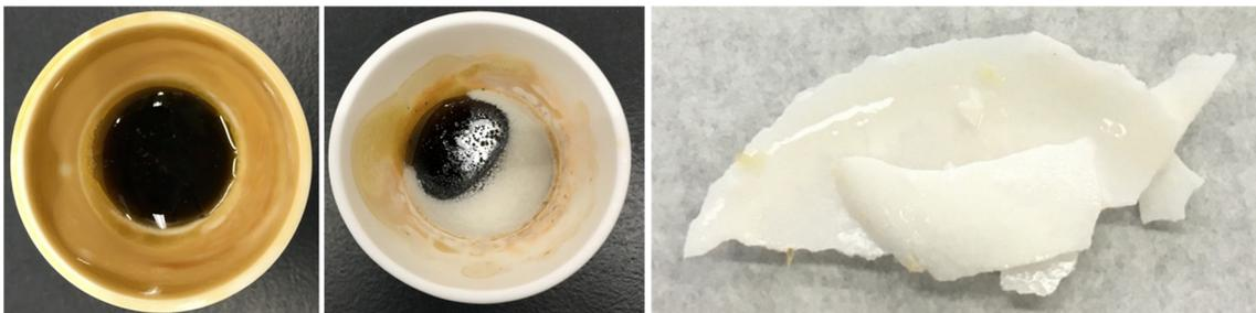
図8 試料外観写真 溶融温度：1200°C(左)，1100°C(中)，1100°C溶融試料表面の白色固形物(右)
