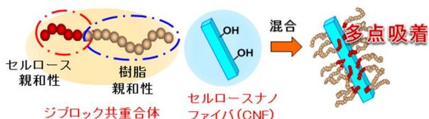
図 1. 高分子分散剤による CNF 表面の疎水化。
