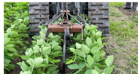
図2 断根に用いたサブソイラー(加工した刃を装着してある)
