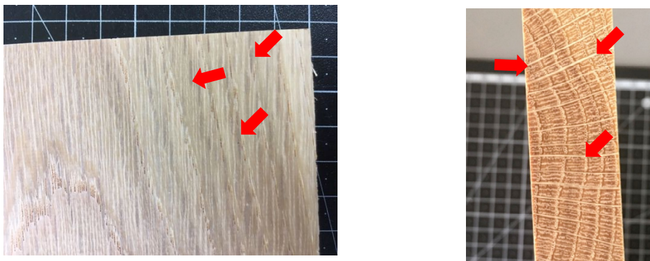
図 1 クヌギ板目面で観察される放射組織（左）、同試料木口面で観察される放射組織（右）
