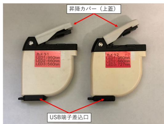
図1. 特定波長のLED照明付カメラの試作機
