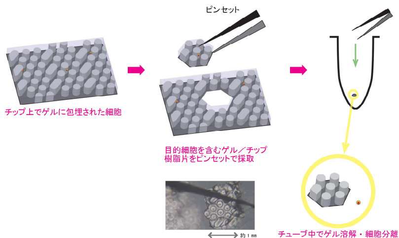
図2 ピンセットを用いたゲル片ピックアップによる細胞回収
