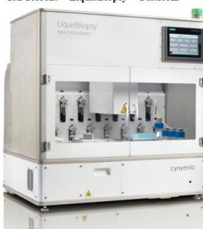
免疫磁気ビーズと size selection の両者も用いる高感度 CTC 採取機器。専用採血管を使用することで cfDNA と CTC を同時に採取できる
