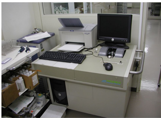
使用した電子スピン共鳴装置 (JES-FR30、日本電子)
