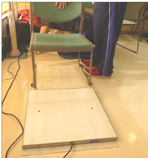
図1．新しく開発した床反力計 従来の既製品よりも幅広い床反力計を開発したことで、バランス能力が低下した者でも評価が可能となった。また、従来の床反力計よりも薄型を達成できたことから持ち運びが可能となった。
