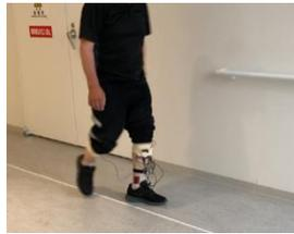
図 3. 筋電位センサを装着した被検者
