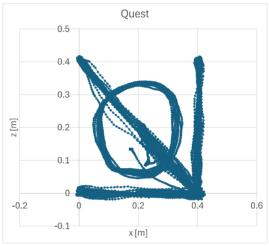
HoloLens では、計測用のマーカーの動きは不安定で、明らかな遅延が観察された。時には、マーカーの動きが跳躍しているようでもあった。それぞれのサンプリング間隔は、以下のようであった。HoloLens は平均 46.9 msec (21.3Hz)、標準偏差 23.7msec、Quest は平均 13.9msec (72.0Hz)、標準偏差 1.0msec であった。明らかに Quest は HoloLens に比べ、サンプリング速度が速く、測定間隔もより安定していることが分かった。今回の目的では最低でも 30Hz 程度の安定した計測周波数を目標としていたため、計測速度は要件をクリアしたと考えられた。表示される画像の上でも、Quest ではマーカーの動きは HoloLens よりもスムースであり、マーカーの跳躍なども観察されなかった。しかし、より詳細に検討すると、速度変化に不自然な動きみられた。
