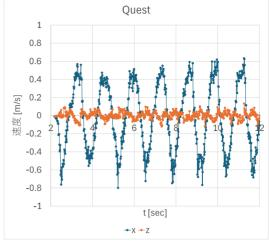
上図は、マーカーの速度変化の一部を示したものである。Quest においても、速度の変動が散見される。一方、HoloLens ではさらにその変化量は大きく、加えて、動きの速度も遅くなっていることが分かる。これは、表示の遅延に対応するため、HoloLens と同様の速度で手を動かすこと困難であったためと考えられた。
