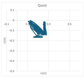
上図は、手の運動時の頭部の動きを示している。手の動き(マーカーの動き)に応じた動きが観察されている。特に HoloLens では大きな動きとなっている。これは、視野角が狭いなどの理由で、手の動きを目だけでなく、頭を動かして追う必要があったためと推測された。
