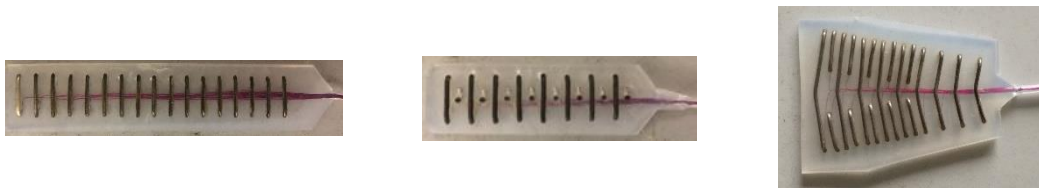
図3 従来の梯子型電極（左）、及び作成したふたつの新電極A（中）、B（右）
