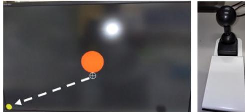
図 3 Test2: 画面四隅に表示される黄丸とジョイスティック
