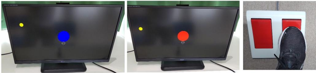
図 2 Test1: 画面中央に表示される青丸、赤丸とアクセルスイッチ踏み込み操作
