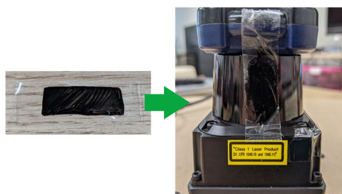
実験に使用したセンサと汚損を模擬した減光フィルム
