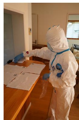
Fig. 2 帰還困難区域内の家屋内における放射性セシウムによる汚染沈着量調査の様子。清浄な布を用いて、一定時間於きに布を回収し、その差分を求めることで経時的な汚染度を評価した。
