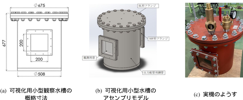
図 4-5 可視化用小型観察水槽の概略寸法, CAD ソフトウェアによるアセンブリモデルおよび実機写真
