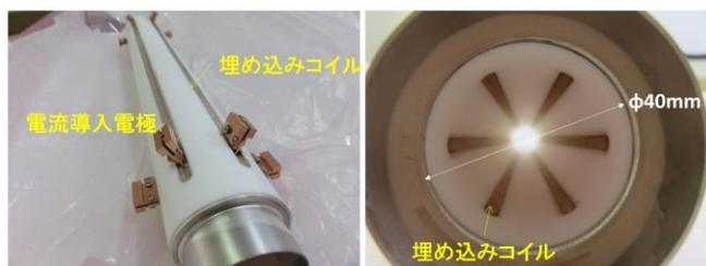
図 5.6 コイル型セラミックスチェンパー体型キッカー
