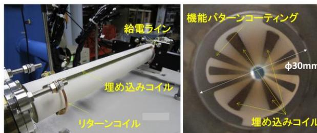
図3. φ30mm口径2極型外観と内面構造
