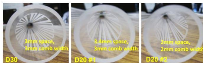
図 6. 円筒口径 φ30mm, φ20mm 対応の精密機能コーティング実証
