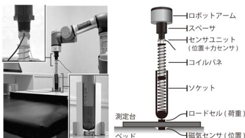
図5 装置評価用ロボットアーム機構
