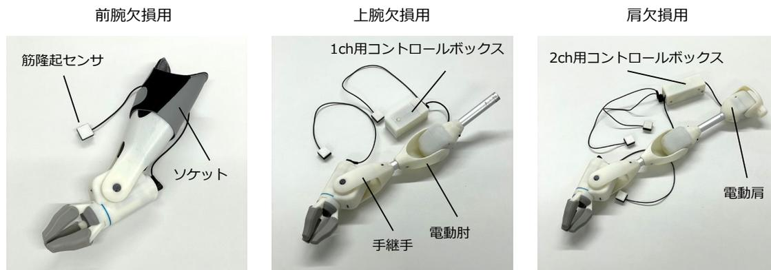
図2 前腕欠損，上腕欠損，肩欠損に対応する3種の電動義手
