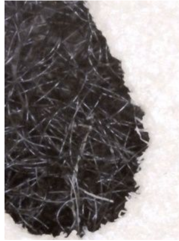
(図1)ガンピ原料料紙では墨をはじく (図2)コウゾ原料料紙での墨付き状態 の切断面に関しては、ノートパソコン接続のデジタル顕微鏡を使用して確認できることが わかり、これまで紙の表面だけを観察していた非破壊料紙調査研究では留意されていなかった 新たな調査ポイントがあることがわかった。(図3・4)
