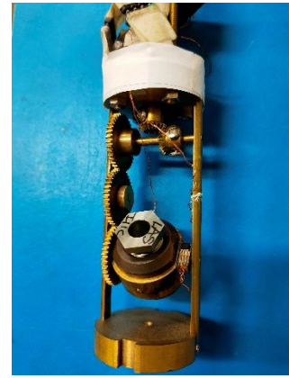
図 2: 本研究で開発したインデンター型圧力セルの磁場中一軸回転機構。
