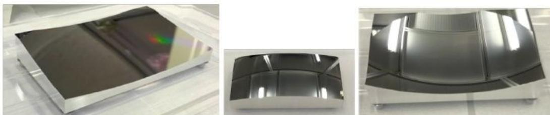
図 2：製作した自由曲面ミラー
