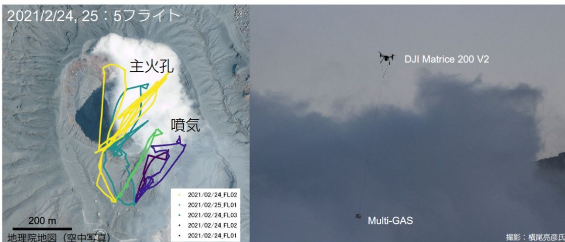
図2 阿蘇山での試験観測時の飛行経路(左)とフライトの様子(右)
