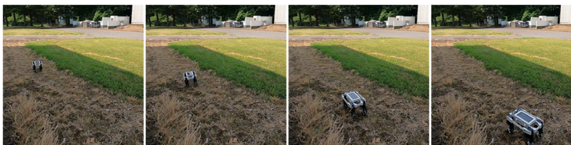
図 5 学習した制御系により不整地歩行を行う四足ロボット
