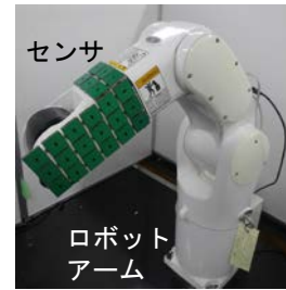
図 3：ロボットアームに実装した ToF・自己容量近接覚・接触センサ
