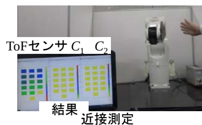
図 5：ロボットアームに実装した ToF・自己容量近接覚・触覚センサ
