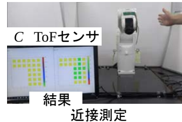
図 3：ロボットアームに実装した ToF・自己容量近接覚・接触センサ
