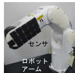
図 5：ロボットアームに実装した ToF・自己容量近接覚・触覚センサ
