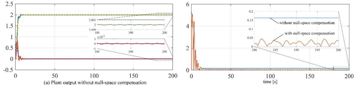
**図4 零空間補償制御を用いた3入力冗長2次系に対する制御シミュレーション結果
