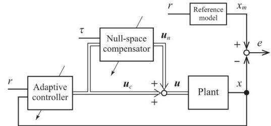
**図2 提案した零空間補償制御系(引用文献<sup>1,2</sup>)**
