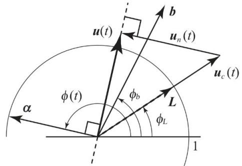
**図3 零空間補償器の動作イメージ(引用文献<sup>1,2</sup>)**
