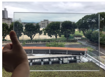
図 3 PEDOT/ s -CNF 遮熱ガラス
