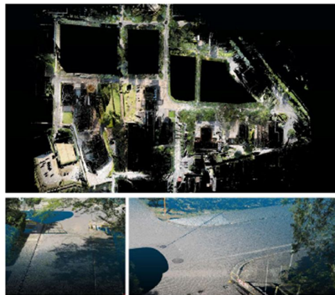
図5 日本大学工学部のレーザ計測点群 [4]
