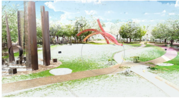
図4 お台場の3Dレーザ計測点群の一部
