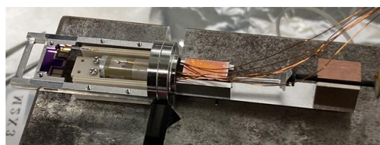
図 2 組み立てたホルダー試料台付近の写真
