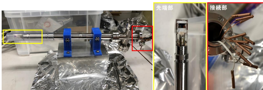
図 3 組み立てた試料ホルダーの全体図及びホルダー先端部と接続部の拡大図
