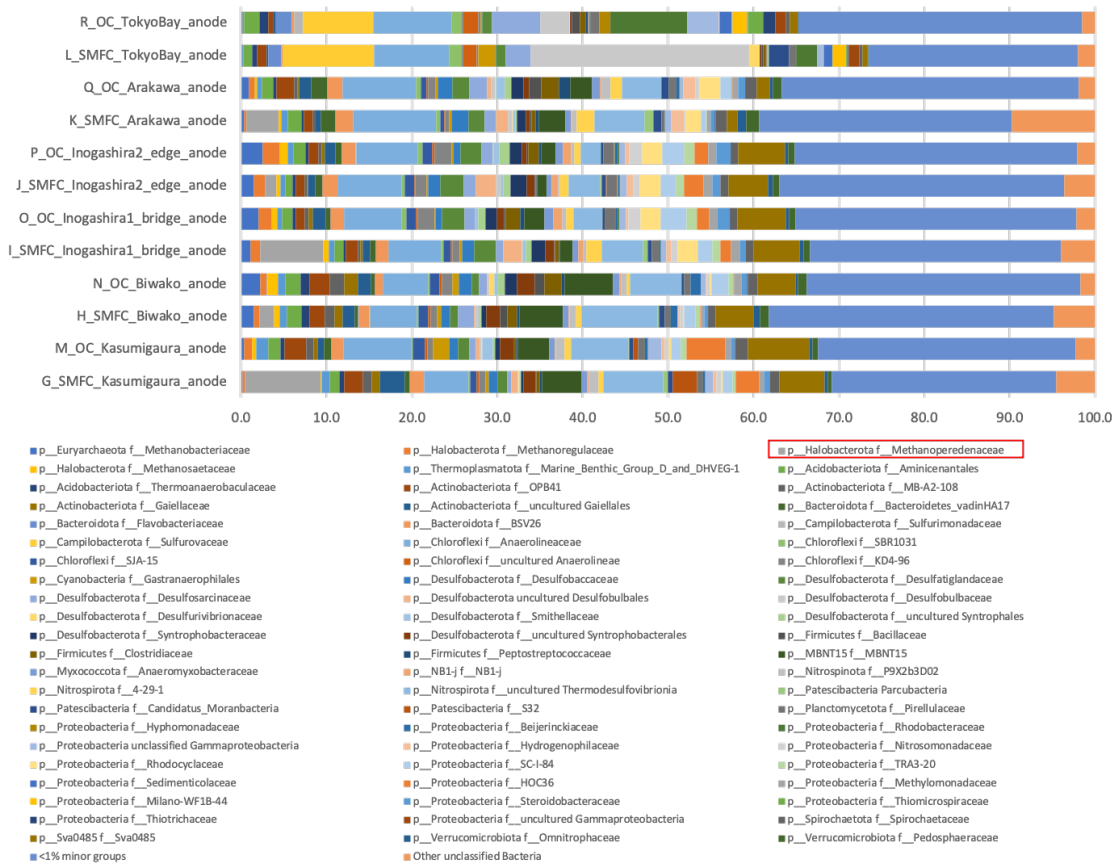
図 3 実験終了時にアノードに付着した微生物の群集構造解析結果
